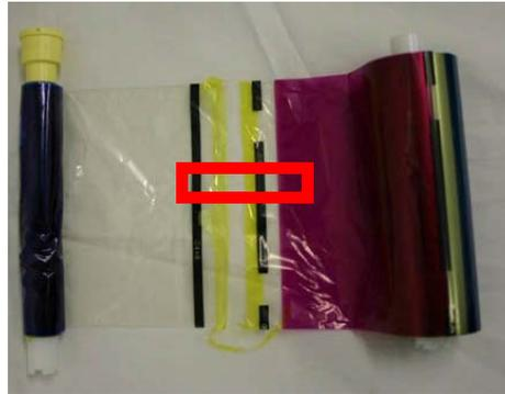
4. Vuelva a meter la cinta en la impresora y haga girar el carrete para tensarla hasta que deje de verse la cinta adhesiva.
