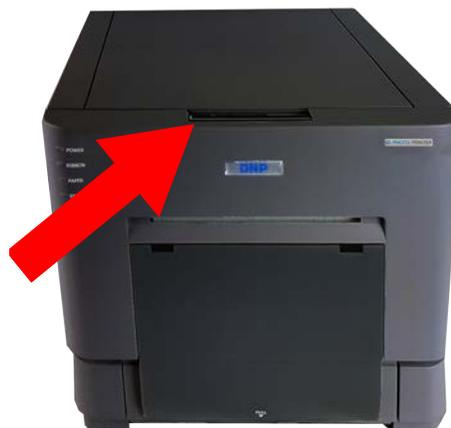
6. Retire el bloque de espuma que protege el cabezal de impresión y guárdelo junto con la caja de transporte.
