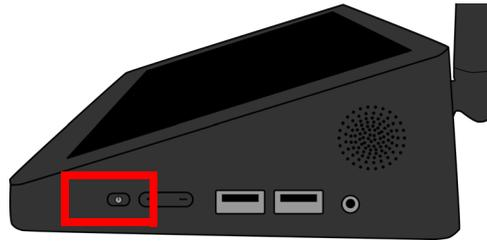
5. Quando o dispositivo WPS Pro é ligado (ON), ele automaticamente detecta a(s) impressora(s) conectada(s) e qual mídia está carregada na(s) impressora(s). Aguarde três minutos antes de tentar conectar quaisquer dispositivos de entrada à rede WPS Pro. Quando o WPS Pro liga, o display de toque na tela mostra o processo de reinicialização e o tempo restante até que o WPS Pro esteja pronto para uso.
