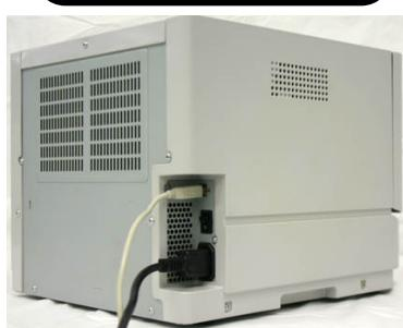
1. 连接电源线和 USB 电缆。打开电源。
