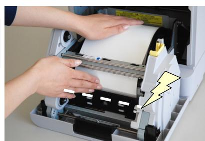
6. Richten Sie das Papier auf die richtige Position für die entsprechende Größe aus. Die Linie L zeigt die Größe von L und 2L an und die Linie PC zeigt PC und A5 an.
