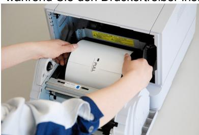
2. Lösen Sie den Öffnungshebel und öffnen Sie die vordere Abdeckung.
